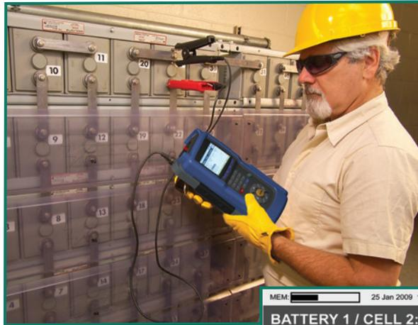
Um die Messgenauigkeit und Wiederholbarkeit zu maximieren, berechnen die EC1000™ und EC2000™ automatisch die richtigen Kalibrierungsfaktoren (Baseline) während des Tests. Außerdem geben zuvor vom Benutzer definierte Messgrenzwerte (Alarmer) automatisch visuelle und hörbare Rückmeldungen „Bestanden“, „Warnung“ und „Nicht bestanden“ über den Fortschritt der Messung jeder Zelle oder jeden Blocks in einem Batteriestrang.
